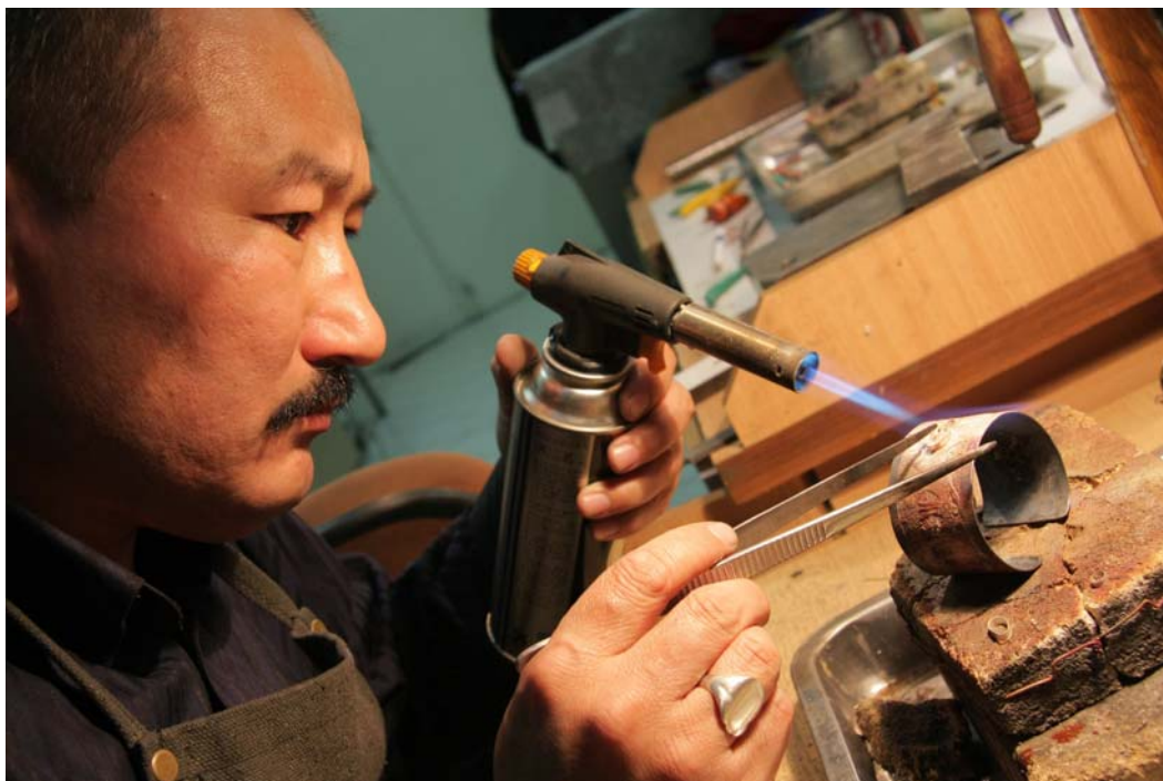
7. Б. Алибай за работой над браслетом (пайка декоративной фигурной накладки).
